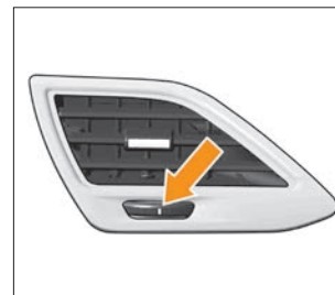
Рис. 8. Боковое левое сопло вентиляции салона (рукоятка управления заслонками сопла в положении «ЗАКРЫТО»)
