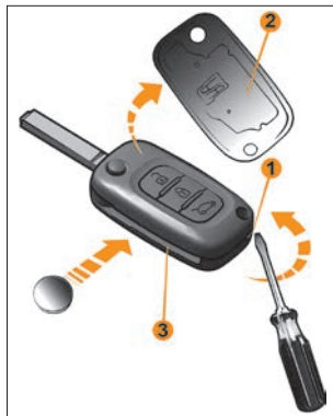
Рис. 10. Замена элемента питания пульта дистанционного управления
