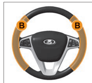
Рис. 2в. Зоны максимального обогрева рулевого колеса (в варианном исполнении)
