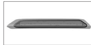
Рис. 16. Дополнительный сигнал торможения (кузов «SW»)
