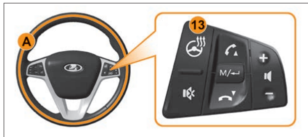
Рис. 2б. Зоны обогрева рулевого колеса (в варианном исполнении)
