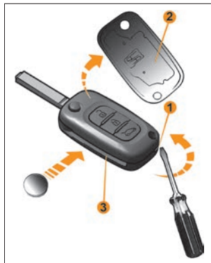
Рис. 10. Замена элемента питания пульта дистанционного управления
