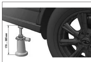
Рис. 3. Положение домкрата при замене колеса
