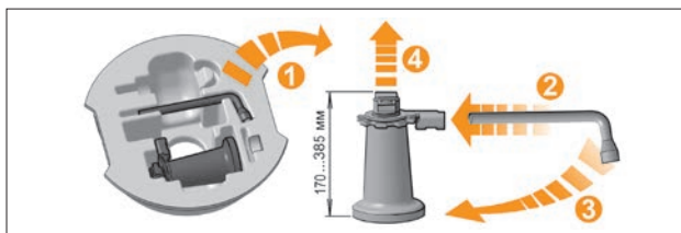
Рис. 5. Положение инструмента в органайзере (вариантное исполнение) и последовательность работы с домкратом
