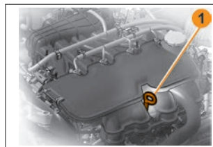
Рис. 4. Проверка уровня масла в картере двигателя
