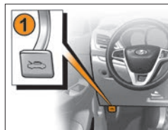
Рис. 1. Рукоятка для открытия капота
