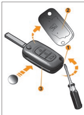
Рис. 10. Замена элемента питания пульта дистанционного управления
