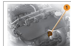
Рис. 4. Проверка уровня масла в картере двигателя
