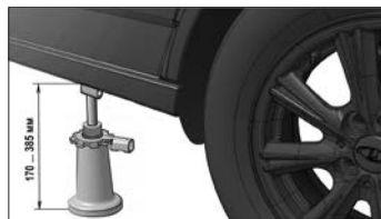
Рис. 3. Положение домкрата при замене колеса
