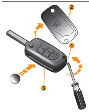
Рис. 10. Замена элемента питания пульта дистанционного управления
