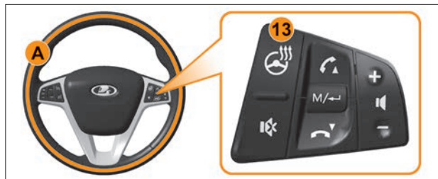
Рис. 2б. Зоны обогрева рулевого колеса (в варианном исполнении)
