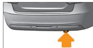
Рис. 10. Расположение задней буксирной проушины (в варианном исполнении)
