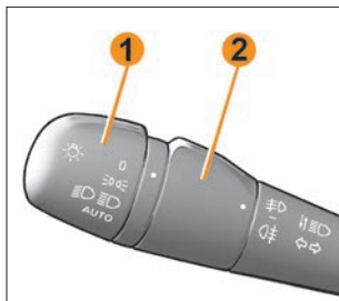
Рис. 16. Кольца управления на рычаге переключателя
