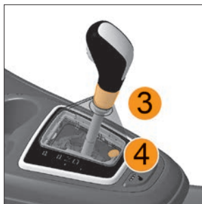
Рис. 21. Снятие блокировки рычага переключения передач
