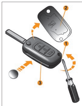
Рис. 10. Замена элемента питания пульта дистанционного управления
