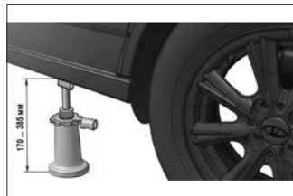
Рис. 3. Положение домкрата при замене колеса
