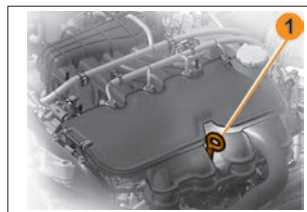
Рис. 4. Проверка уровня масла в картере двигателя
