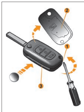
Рис. 10. Замена элемента питания пульта дистанционного управления
