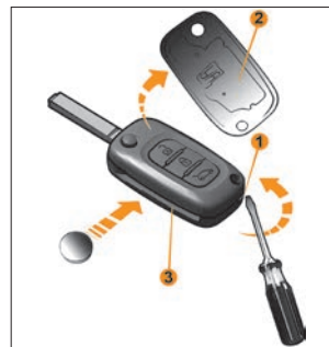
Рис. 52. Замена элемента питания пульта дистанционного управления
