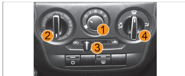
Рис. 37. Блок управления системой вентиляции и отопления
